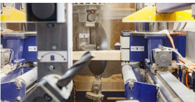
Zurück in Gonten werden die Bohlen bei der Appenzeller Massivholz AG auf einer der modernsten CNC-Maschinen millimetergenau abgebunden. Im nächsten Schritt werden sie zu vorgefertigten Holzbau-elementen zusammgebaut.
