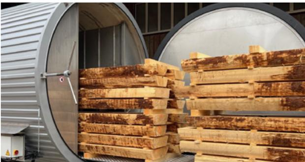
Jede einzelne Bohle lagert für 14 Tage in der Vakuum-Trocknungsanlage, bevor der nächste Arbeitsschritt in Angriff genommen wird.
