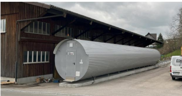
Für die Trocknung der bis zu 9 Meter langen Bohlen wurde extra eine spezielle Trocknungskammer angeschafft. Wir setzen auf 100% natürliches Holz ohne Verleimung.
